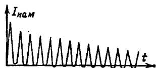
Рис. 16-25. Характер изменения намагничивающего тока по времени.
